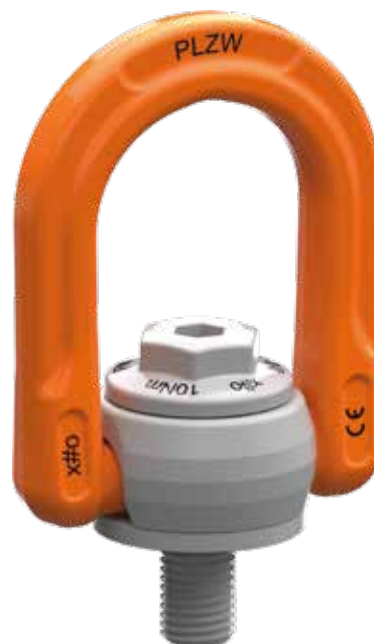
Figura 1: PLZW-FIX-SP (con muelle para fijar la posición del anillo de elevación, tornillo reemplazable con herramienta)
