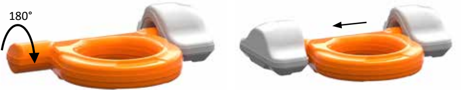
C. Rabattre l'anneau de 180° D. Poser le deuxième support à souder, l'aligner et le souder
