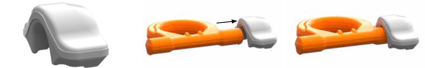
A. Souder le premier support à souder B. Insérer l'anneau dans le support à souder (veiller à ce qu'il soit correctement positionné – les bosses centrales doivent être orientées vers le haut)
