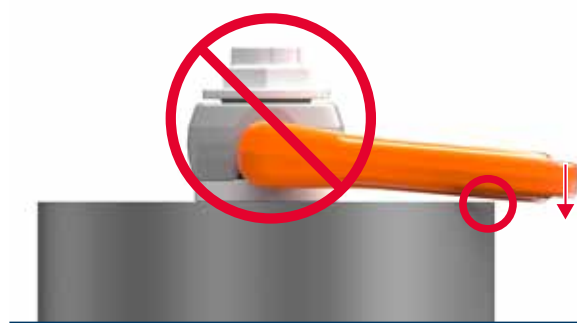
Unzulässige Belastung, wenn der Lastring an Kanten oder Oberflächen anliegt:
