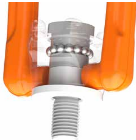
Das integrierte Kugellager ermöglicht es dem PLOW, sich auch unter Last reibungslos zu drehen.
