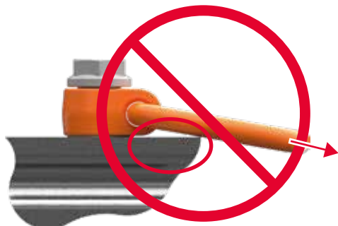
Fehlbelastung durch Anliegen an Kanten und Flächen
