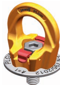
Obrázek 4: Poloha „B“. Bez dotyku klapky se šroubem. Pouze v této poloze je vázací bod připravený k použití.
