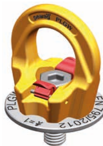
Obrázek 3: Poloha „A“. Obě klapky se dotýkají šroubu. Přípustné pouze při montáži a demontáži.
