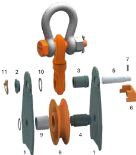
Abbildung 3: Zusammenbau des Snatch Blocks inklusive Wirbel
