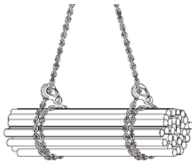
Bild 11: dubbelt surrad i samma riktning
