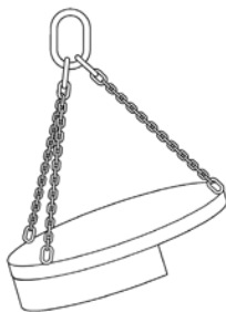
Obrázek 15: Většinu zátěže nesou dva prameny řetězu
