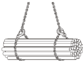
Bild 12: enkelt surrad i motsatt riktning
