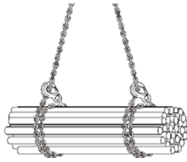
Bild 11: doppelt geschnürt gleichsinnig
