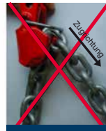
falsch eingehängte Kette
