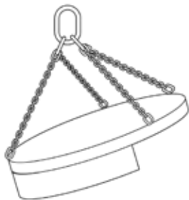
Bild 14: Der Großteil der Last wird von einem Kettenstrang getragen
