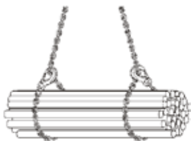
Obrázek 12: jednoduché vázání v opačném směru
