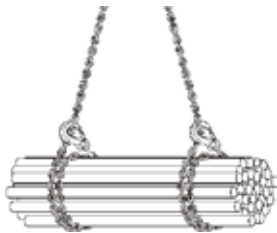
Obrázek 11: dvojité vázání ve stejném směru
