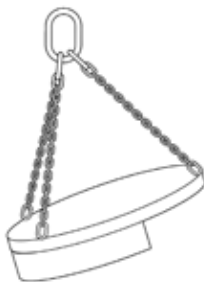
Obrázek 15: Většinu zátěže nesou dva prameny řetězu
