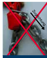
falsch eingehängte Kette
