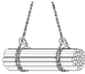
Bild 11: doppelt geschnürt gleichsinnig
