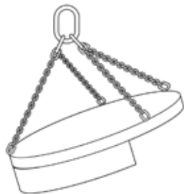
Obrázek 14: Největší část zátěže nese jeden pramen řetězu
