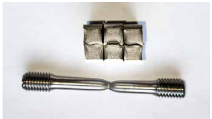
Jede Produktionscharge wird einer mechanischen Prüfung unterzogen, die eine individuelle Rückverfolgbarkeit jedes Schäkels gewährleistet.
