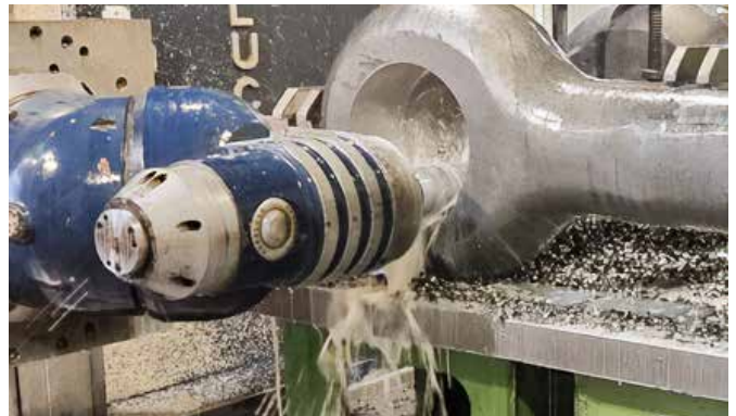
Schäkel und Bolzen CNC-gefräst
