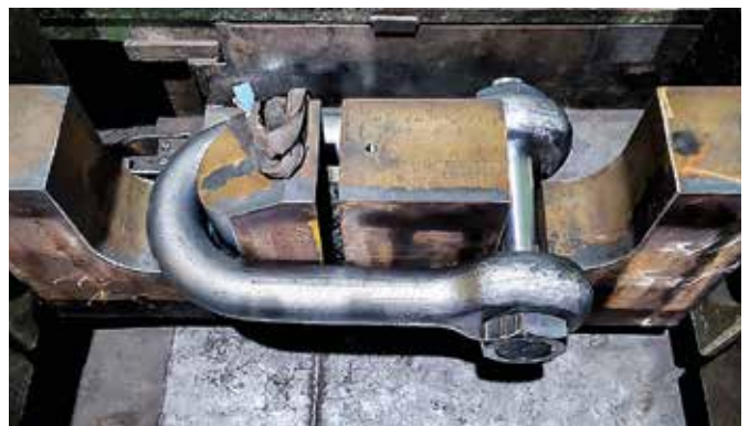
Probetest (2 x WLL) mit Schnellspannsystem
