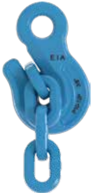
Richtiges Verkürzen: Die Kette wird in den Verkürzungsschlitz eingehängt
