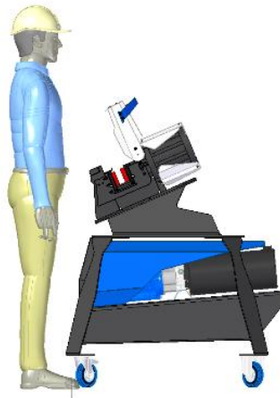
Bild 10: Hauptbedienplatz an der Maschine
