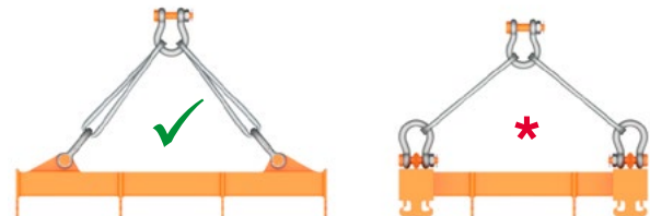
* Se debe reducir la carga máxima de trabajo (CMT); consulte la tabla «Reducción de la CMT en función de la dirección de carga».
