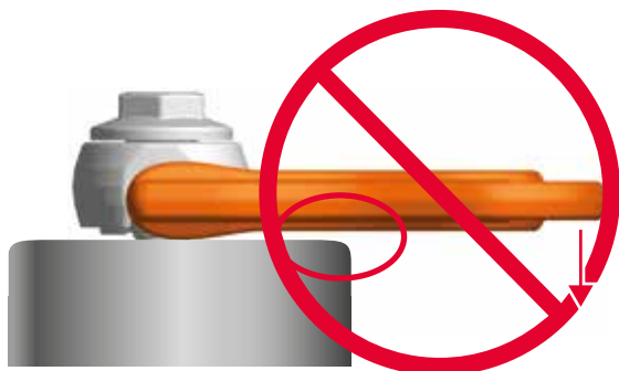
Fehlbelastung durch Anliegen an Kanten oder Flächen
