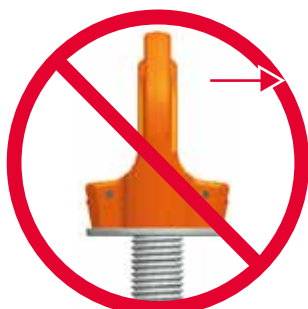
Nicht erlaubte Belastungsrichtungen
