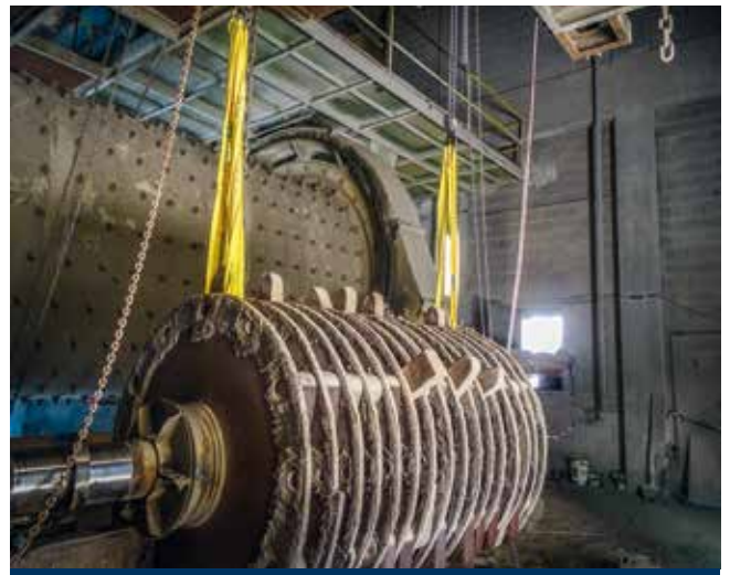
Hebevorgang mit Rundschlingen
