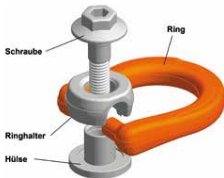
Bild 4: Explosionsansicht der Einzelteile
